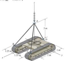
**Exercício 1.19** – Calcular a tensão em cada cabo de forma que o sistema suporte um bloco de 100kg (ADOTAR aceleração da gravidade de 9,81 m/s²) em equilíbrio. [Resposta: :  $F_{AB} = F_{AC} = 1,96kN, F_{AD} = 2,94kN$ ]
