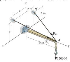
**Exercício 1.12** - Determine a magnitude das componentes do vetor **F** atuando ao longo e perpendicular à linha AO. [Resposta:  $\theta = 33,2^\circ$ ;  $F_{AO} = 46,9kN$ ;  $F_{1.AO} = 30,7kN$ ]
