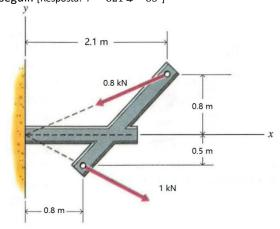
**Exercício 1.3** - Determine a magnitude da força resultante e sua direção no sentido anti-horário, a partir do eixo x positivo. [Resposta:  $\vec{r}$ = 413 N;  $\theta$ = 24.2°]
