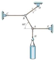
**Exercício 1.18** - Determinar a força em cada cabo de forma que uma máquina de 8 toneladas seja mantida suspensa.. [Resposta:  $F_{AB} = F_{AC} = 16,6kN,F_{AD} = 55,2kN$ ]
