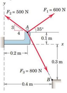
**Exercício 1.2** - Determine o vetor resultante  $\vec{r}$  em coordenadas polares das duas forças ilustradas as seguir. [Resposta:  $\vec{r}=821 \pm -83^{\circ}$ ]
